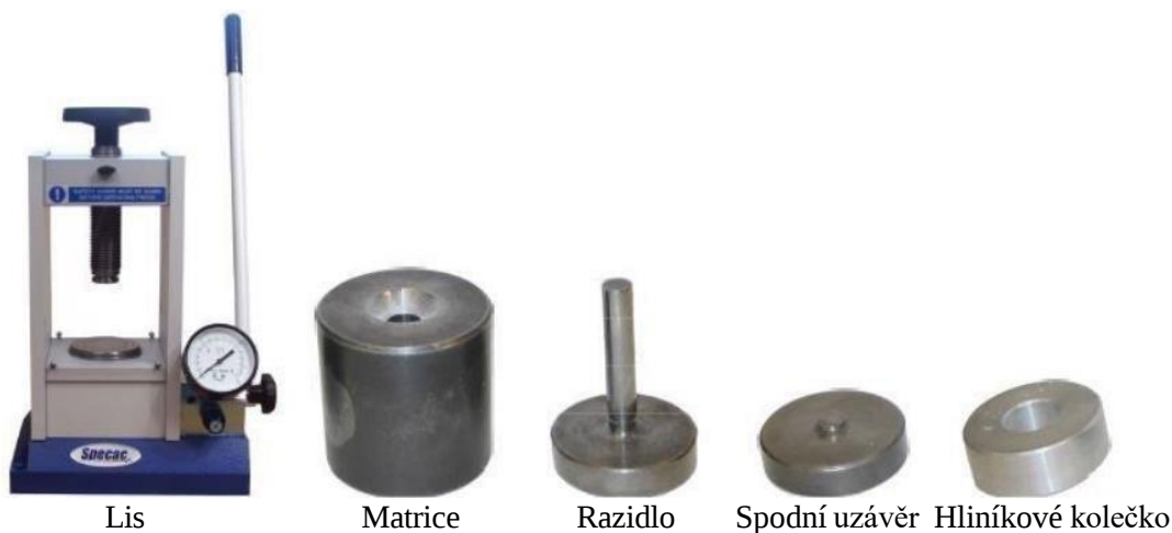
Obr. 1: Hydraulický lis Specac a příslušenství k výrobě tablet [3]
